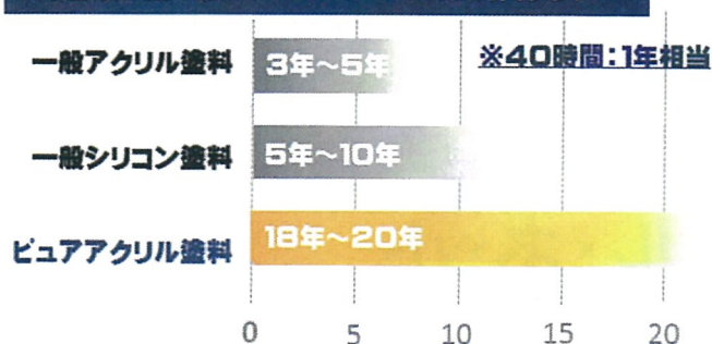
促進耐候性試験(スーパーUV) 720時間クリアー
