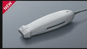
名称: リニアプローブL25v 周波数帯域: 6~13MHz 用途: 動脈、静脈、肺、表在組織、神経、筋骨格、眼科
